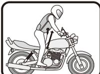
4 Determinar o comprimento útil da correia ficando de pé sobre os ganchos.
