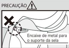
Não prenda o cabo de conexão nos encaixes de metal da alça que pode estar quebrada ou pode sair e o sistema não ser ativado
