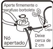
5 Prenda o cabo de conexão firmemente no bloqueador de nó, faça um nó e corte o excesso, deixando mais de 2 cm de comprimento extra e coloque uma capa na extremidade cortada.
